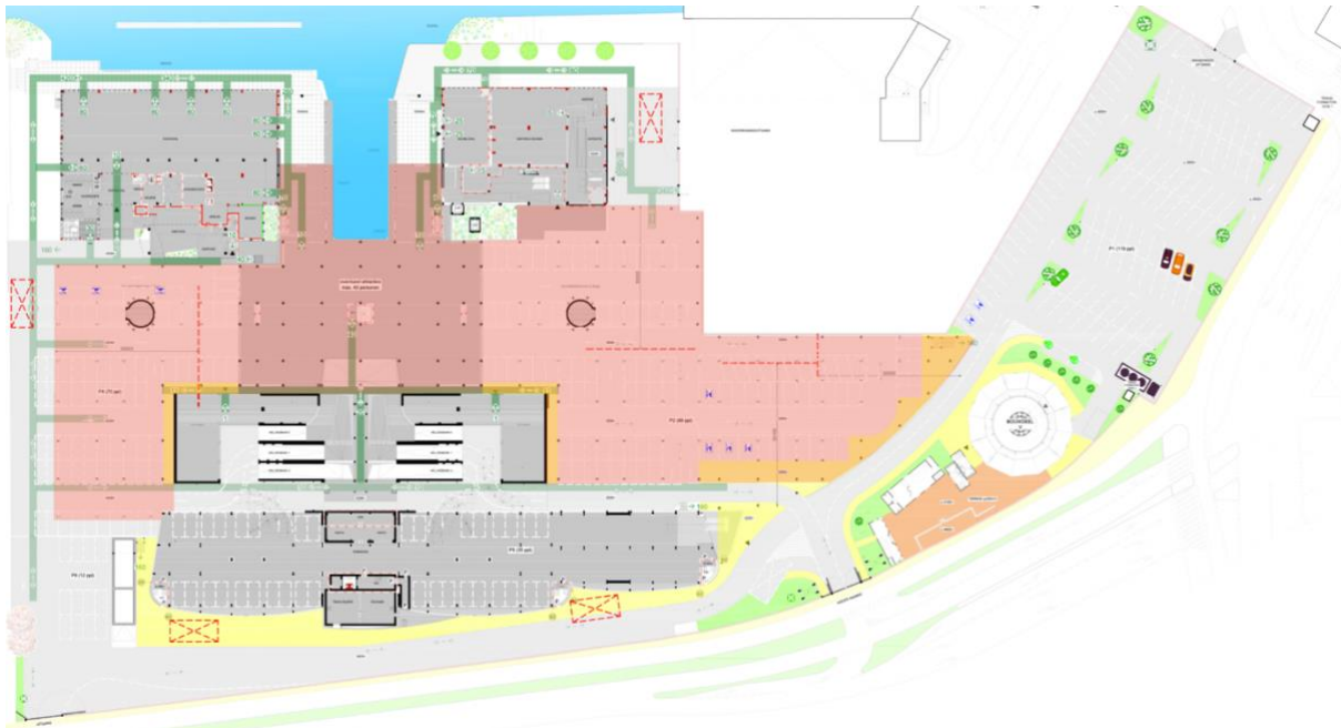
Figuur 1 Plattegrond attractiepark met in rood de betonconstructie boven de open parkeervoorziening
